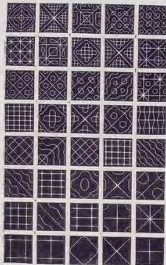
Disegni ottenuti per la vibrazione di corpi sonori su nel era sparsa della sabbia. (Rambosson).
